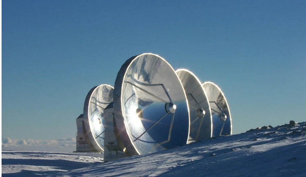
FIGURE 5.15 – Interféromètre du plateau de Bures, en France. Les antennes millimétriques, de 15 m de diamètre chacune, peuvent être déplacées pour changer la résolution de l'instrument.
