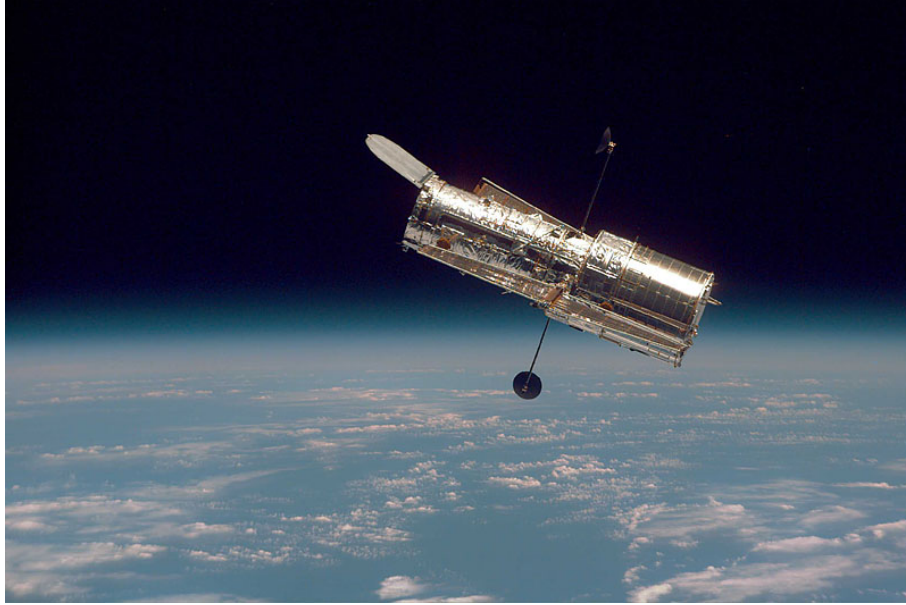
FIGURE 5.12 – Image du télescope spatial Hubble. La trappe protégeant l'entrée du tube est ouverte et les antennes à haut débit transmettant les données vers le sol sont bien visibles.
