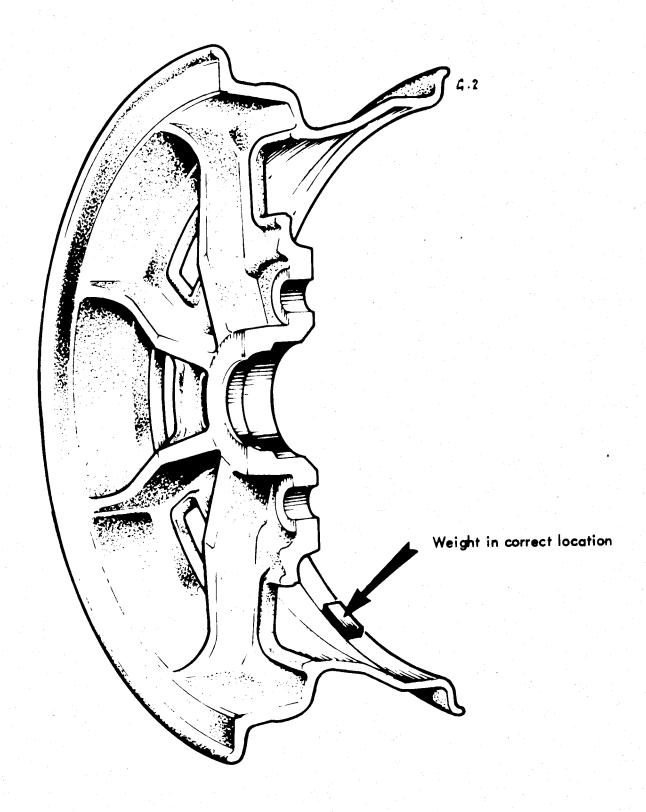
Fig. 1. ALLOY WHEEL SHOWING CORRECT LOCATION
